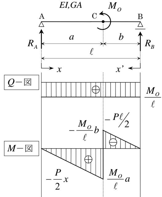
【問題 SE-B-1】 下図に示す張出ばりのひずみエネルギー $U$ を求めよ。ただし、はりの曲げ剛性は $EI$ 、せん断弾性係数は $G$ 、断面積は $A$ とする。
