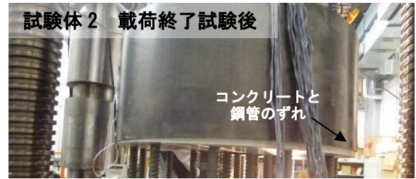
写真-1 試験体 2 の破壊状況
